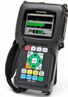
Das Messgerät zeigt bei 0,005 Zoll keinen Messwert ohne klare Echotrennung an
